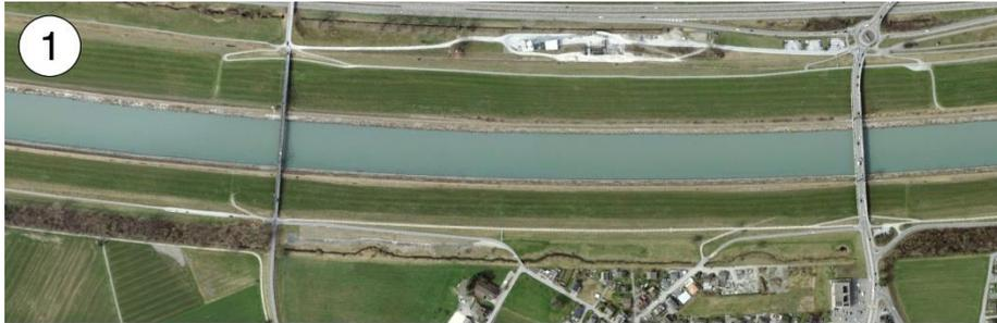
1 Kanalisiert, stark eingeeignet, ebene Sohle
