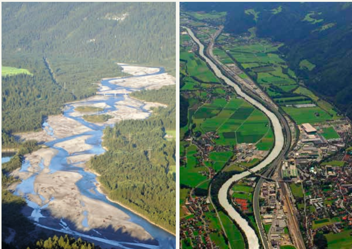
Abb. 2: Schutzgebiet Mittlerer Lech (links); kanalisierter, stark verbauter Flusslauf des Inn bei Jenbach (rechts).
